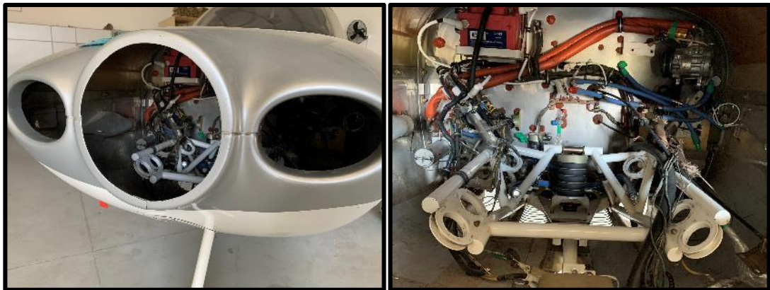
FOTO 8: Detalhe interno do local de instalação do motor de combustão, sem o componente.
